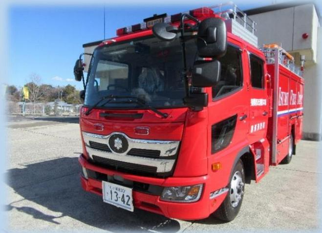
水槽付消防ポンプ自動車は、1,500 リットルの水を積載しており、火災などの災害現場に出動します。
