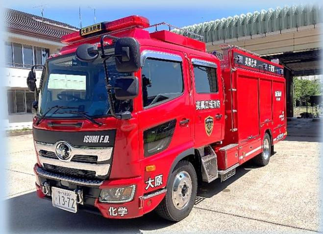
化学消防自動車は、水と薬液を混合して、発泡した消火薬剤を放射する機能を有しており、水では消火できない油などが燃えた火災を消火することができます。
