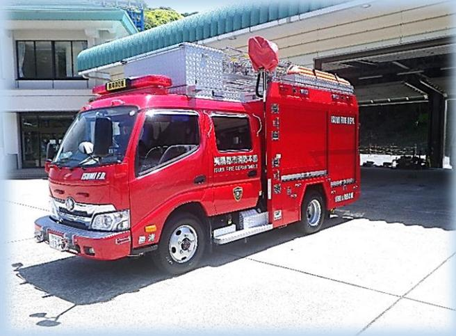
消防ポンプ自動車(交通救助対応)は、火災出動時には消火栓や防火水槽から水を吸い揚げて消火したり、現場に近いほかの消防車に水を送ります。
